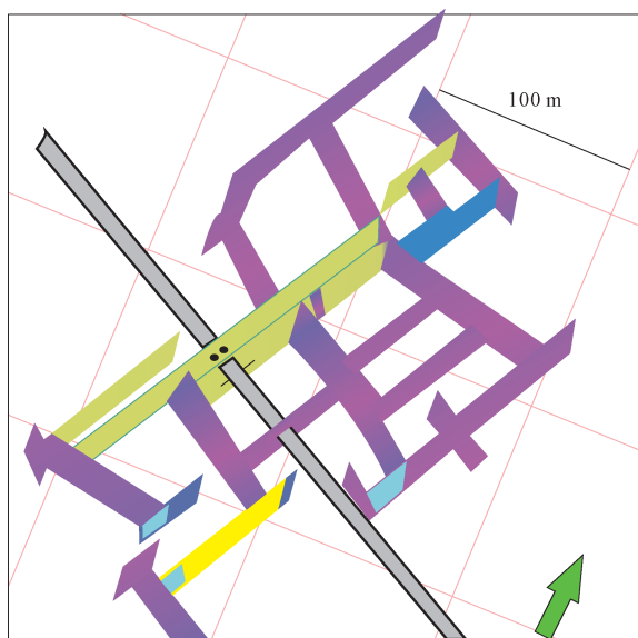
图 6 垂直的天然裂缝性储层中形成的水力裂缝网络 [52]
